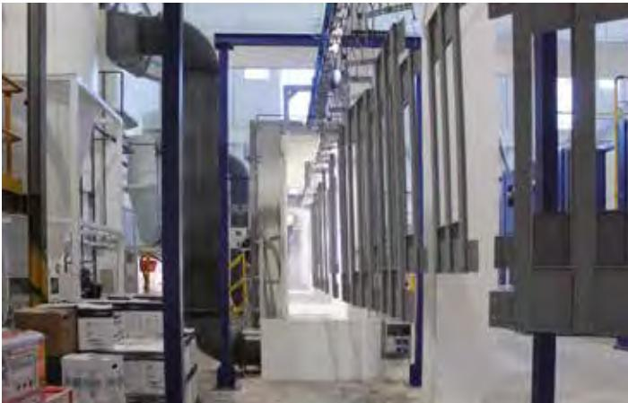
**10 e 11 - Particolari dei due impianti a polveri nelle aree delle cabine di spruzzatura.**
