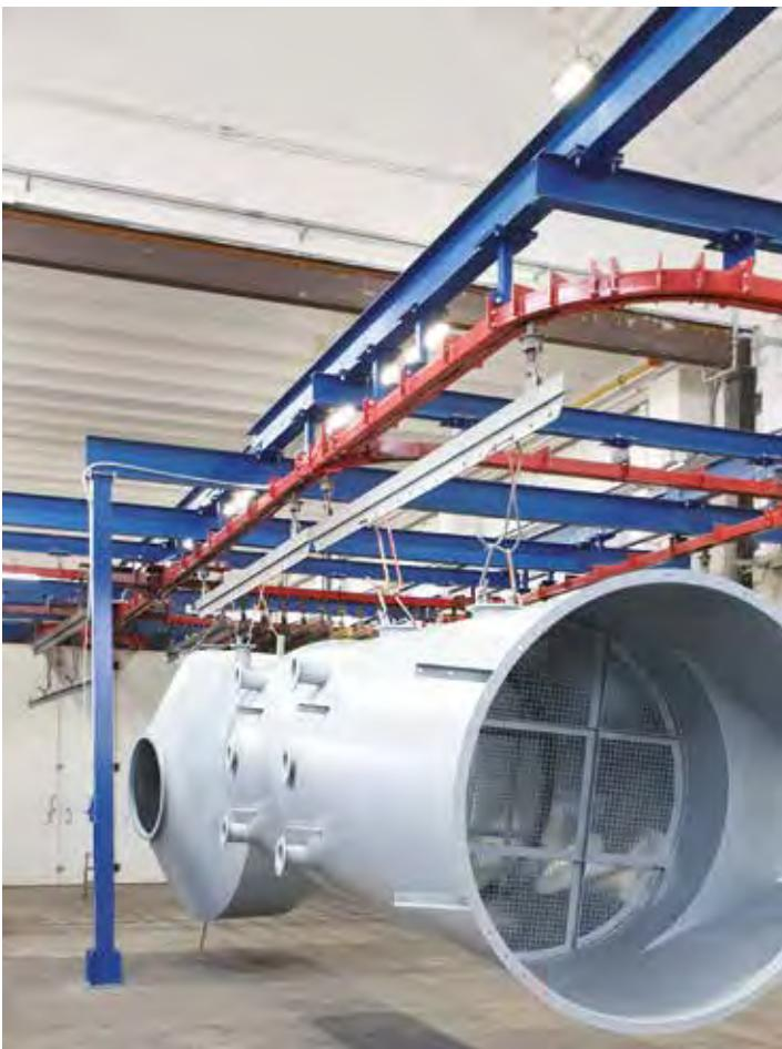
**21 e 22 - Gli impianti statici di verniciatura a polvere manuale sono necessari per trattare strutture metalliche di qualsiasi dimensione e peso.**
