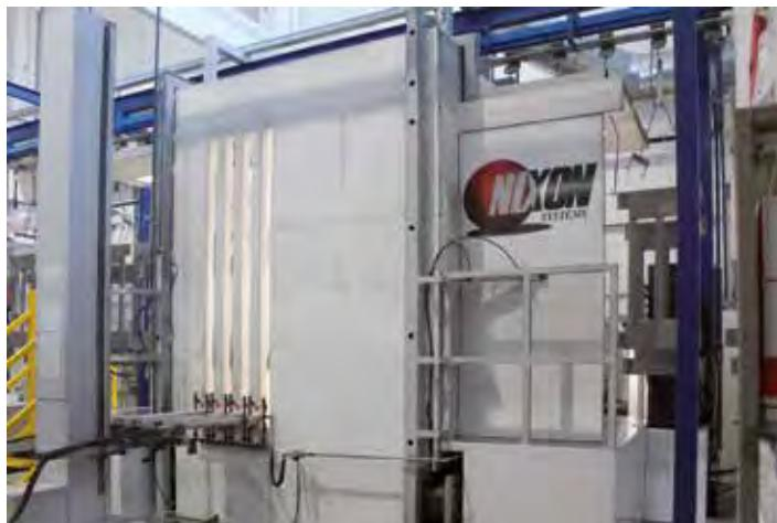
7 - L'innovativa cabina di spruzzatura a polveri con aspirazione dell'overspray dalle pareti laterali.
